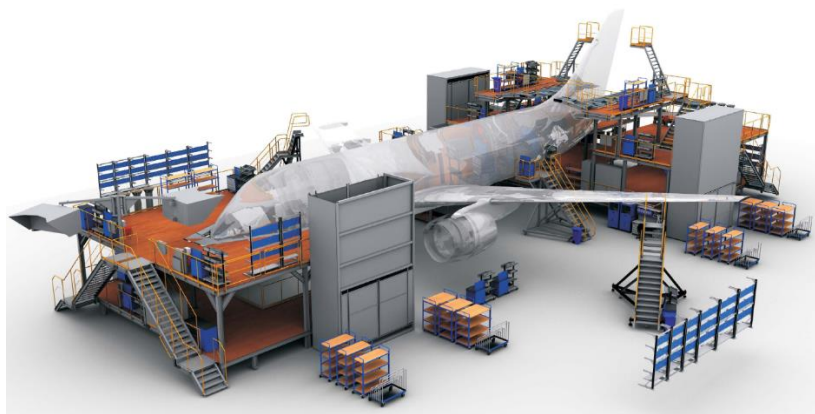
Рис. 14. Концепция организации рабочих мест на сборочной линии МС-21
